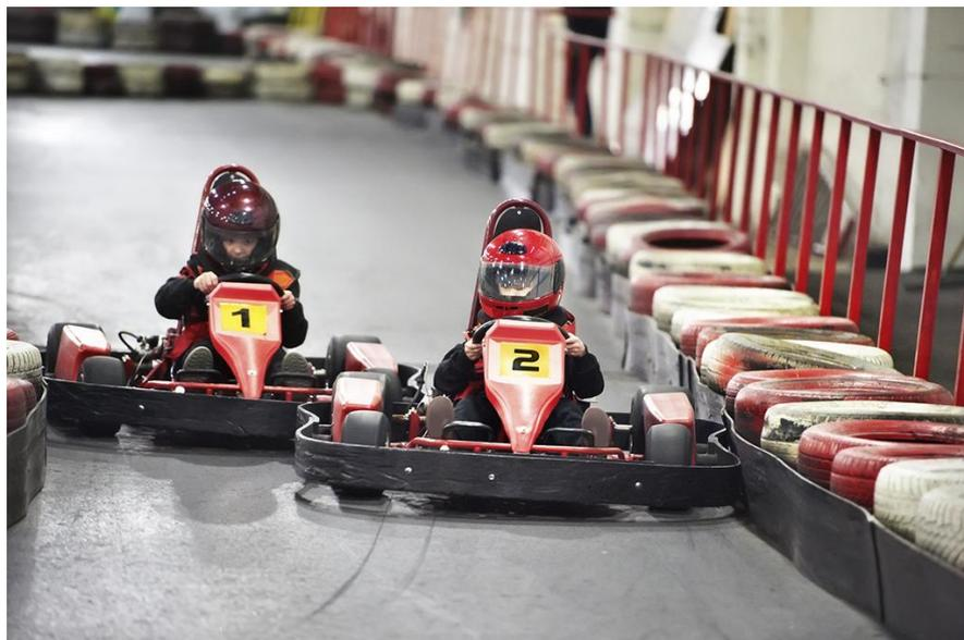
Os pneus que se colocam nas bermas das pistas de carros, permitem, em caso de colisão, aumentar o intervalo de tempo que esta dura, uma vez que são feitos de material facilmente deformável.
